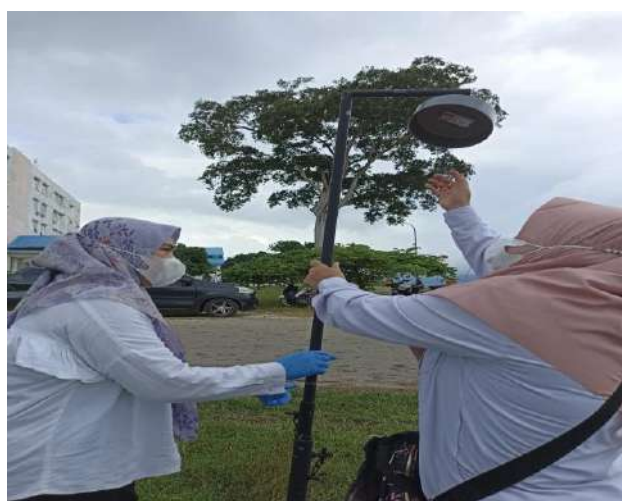
Gambar : Pemasangan Alat Pengukuran Kualitas Udara Ambien dengan Metode Passive Sampler Sumber : DLH Kab. Buton
